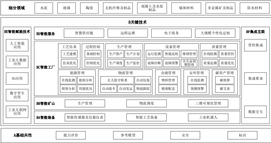
图 1 建材行业智能制造标准体系结构图
